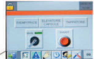
Tastierino Touch-screen a colori per la gestione di tutte le regolazioni della macchina (tempi, allarmi, ecc..).
